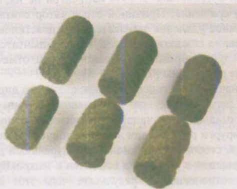
Рис. 2. Имплантаты из пористого никелида титана
